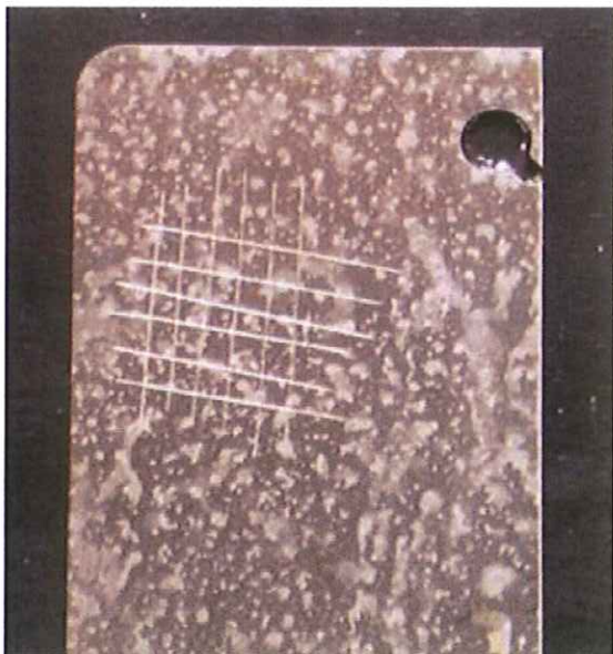
Testilevy puhdistettu VpCI-429:llä ja käsitelty VpCI-386 Kirkas
